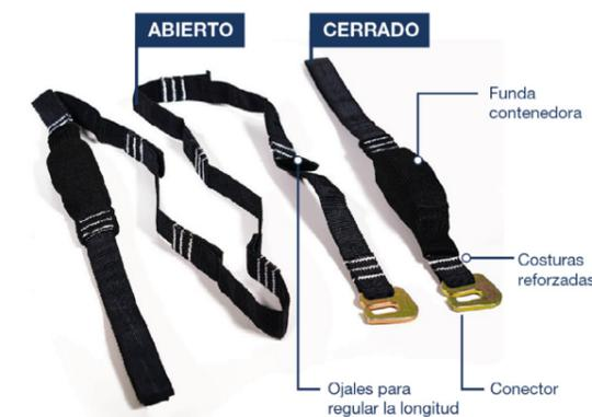
El Dispositivo antitrauma DPA911001 permite al trabajador, que está suspendido, colocarse en posición vertical en su arnés y así aliviar la presión sometida a las arterias y venas en los alto de sus piernas
