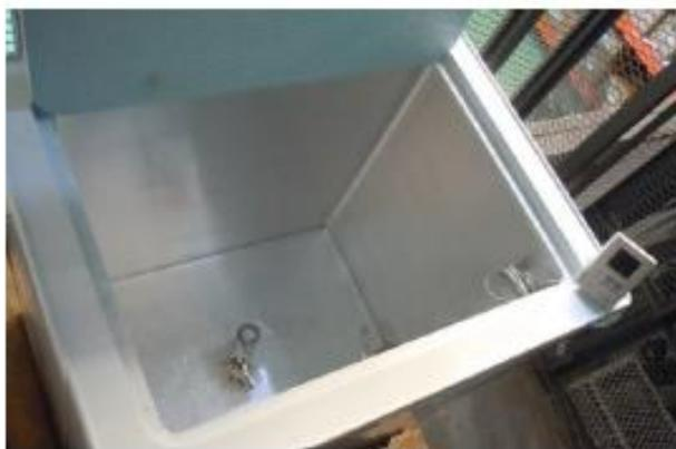
Colocar el dispositivo anticaída durante 2 horas en el freezer y mantenerlo a una temperatura de  $-30\text{ }^{\circ}\text{C} \pm 2\text{ }^{\circ}\text{C}$ .
